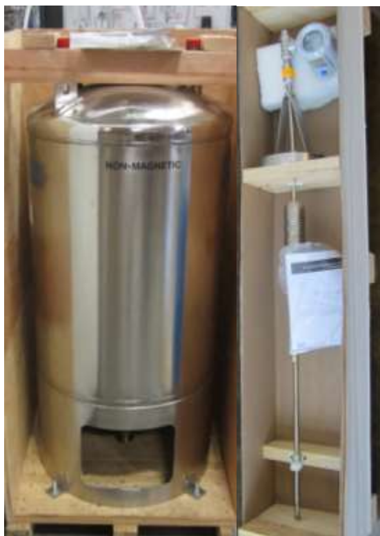
Figure 6. LNG dewar and level sensor.
